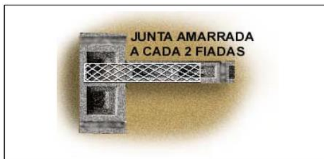
Figura 2: Junta com tela de aço entre alvenarias
